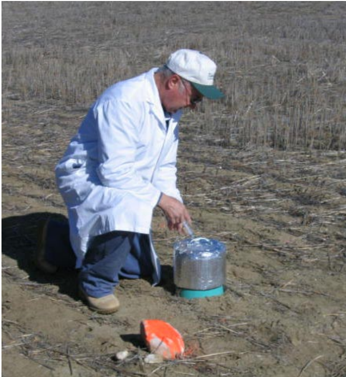
Un technicien prélève des échantillons de gaz à effet de serre du sol dans les champs en chaume.
